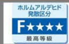
ホルムアルデヒド 発散区分 F★★★★ 最高等級 ホルムアルデヒドの取り組みについて ホルムアルデヒドの放散量が最も少ない原材料 を使用しています。
